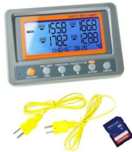
Figure 31 : Sonde enregistreuse de données avec thermocouple de type k
