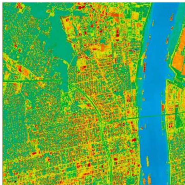
Figure 41 : Image thermique du centre-ville de Baton Rouge en Louisiane prise le 11/05/1998 à 13h00 heure local par un avion équipé par la NASA. La température estimée varie entre 25°C pour la végétation et 65°C pour les toitures (Gorsevski et al., 1998)
