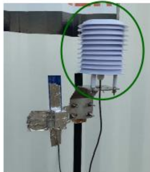
Figure 21 : Capteurs pour l'environnement du conteneur
