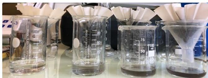
Figure 8 : Différence de turbidité entre les différentes eaux de lavage (granulométrie plus importante à gauche)
