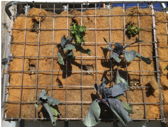
Figure 5 : Cage contenant seulement de l'isolant
